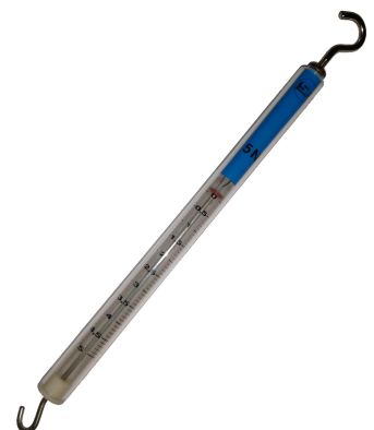
Figur 2.4: Et dynamometer der kan måle kræfter op til 5 N.
